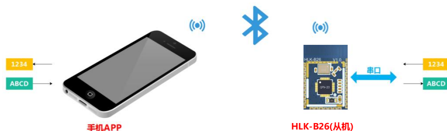
图 1 一对一蓝牙连接透传功能示意图
