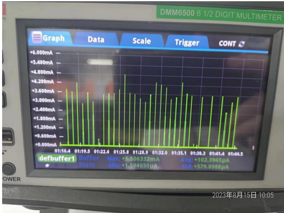
图 5 使能低功耗休眠状态下的工作电流图示
